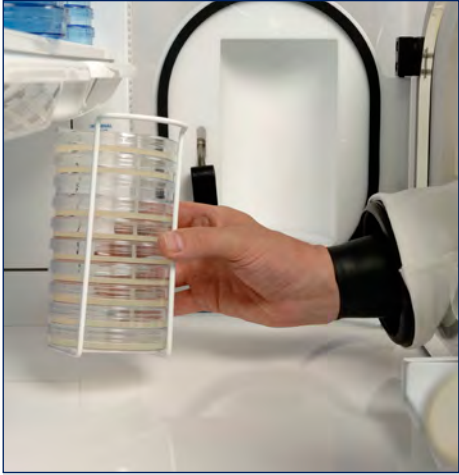
Transfert d'échantillons à l'intérieur d'une DG250
